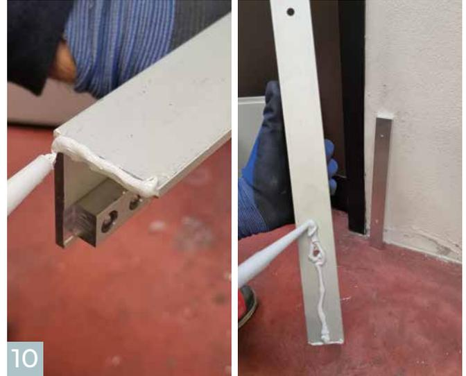
Auf der Wandseite des Montagewinkels, an der Rückseite der Nieten sowie auf die Bodenaufstandsfläche des Montagewinkels Dichtstoff auftragen.
